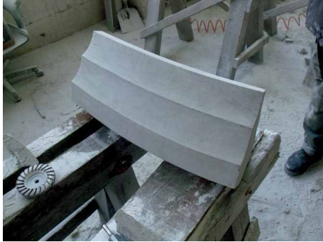
Bild 57 fertige Kehlen Außenseite Rippen
