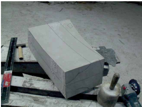
Bild 43 Reißen Profilhauptlinien auf fertigem Krümmling
