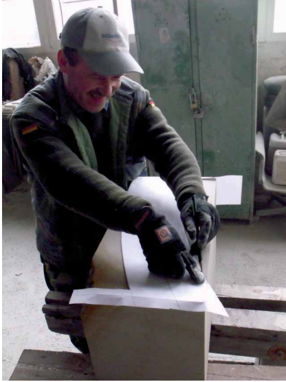
Bild 03 Reißen Grundrissfigur – Innenradius
