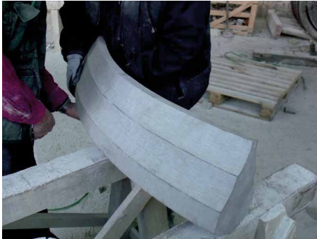
Bilder 100 und 101 Vergleich Krümmung und Oberflächen durch Aneinanderhalten beider Rippenwerkstücke
