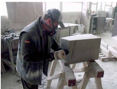
Bild 63 zweite Fugenfläche abarbeiten
