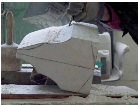
Bild 55 Ausarbeiten Kehlung Außenseite
