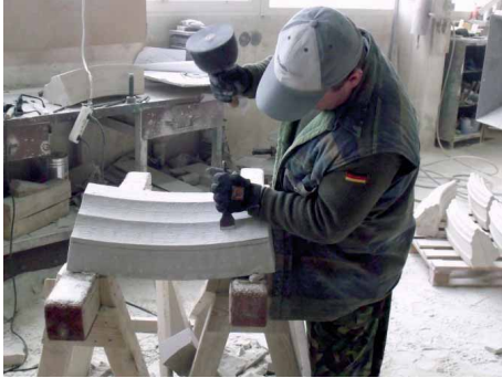
Bild 91 und 92 Ausarbeitung der Kehlungen mit beginnendem Randschlag und danach sphärisch gekrümmte Kehlfläche freihändig
