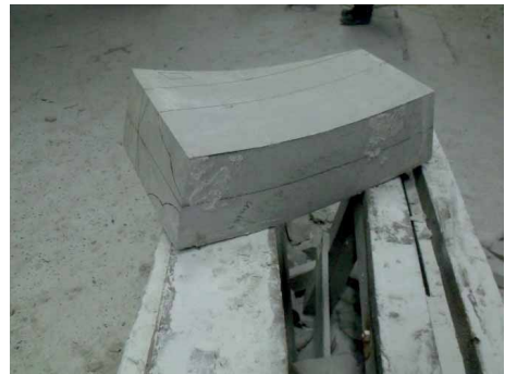
Bild 44 Reißen Profilhauptlinien auf fertigem Krümmling
