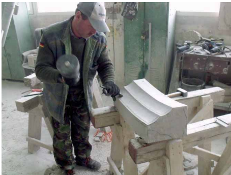
Bild 89 Ausarbeitung der Kehlungen mit beginnendem Randschlag und danach sphärisch gekrümmte Kehlfläche freihändig
