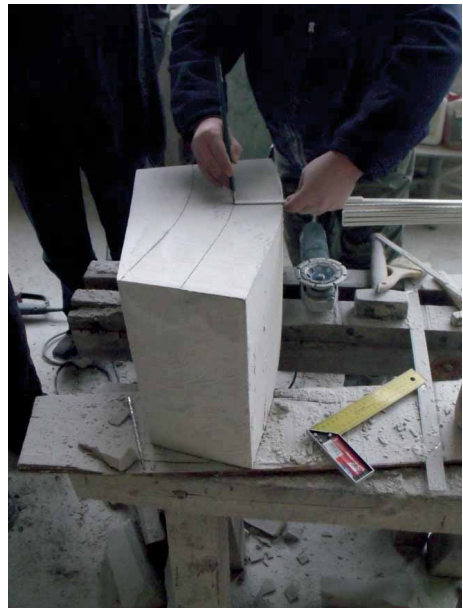
Bild 38 Reißen Untere Mittellinie auf gekrümmter Unterseite
