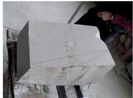
Bild 20 Nachzeichnen Bogenaustragung über gestochene Punkte
