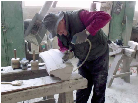
Bild 53 Ausarbeiten Kehlung Außenseite
