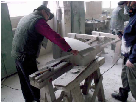
Bild 11 Abarbeiten erste Krümmung (hier prüfen Ebenheit)
