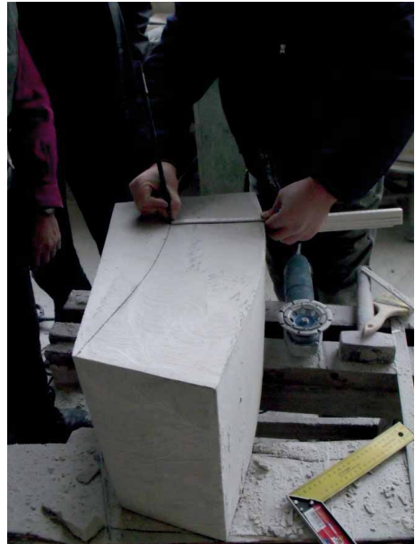
Bild 36 Reißen Innenradius auf gekrümmte
