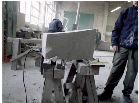
Bild 34 Prüfen (radiale Rechtwinkligkeit) Krümmung Unterseite
