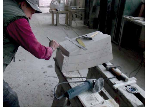
Bild 40 Abarbeiten innere Krümmung
