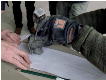
Bild 05 Reißen Rippenmittellinie mit Reißnadel
