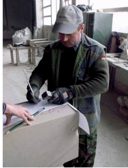
Bild 04 Reißen Grundrissfigur – Rippenmittellinie (mit Reißnadel)
