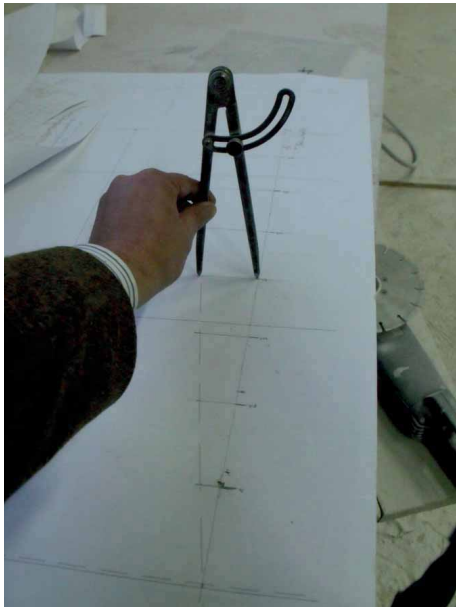
Bild 73 Abgreifen des Lotes zwischen Basislinie und Bogenaustragung und Übertragen auf gleiche Teilung auf dem Krümmung
