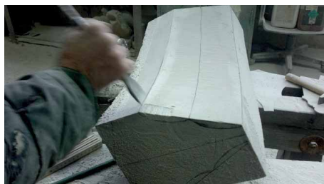
Bild 46 Randschlag zum Ausarbeiten der Kehlung
