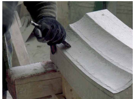
Bild 90 Ausarbeitung der Kehlungen mit beginnendem Randschlag und danach sphärisch gekrümmte Kehlfläche freihändig
