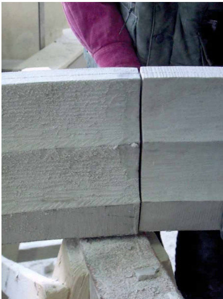
Bilder 102 und 103 Vergleich Krümmung und Oberflächen durch Aneinanderhalten beider Rippenwerkstücke
