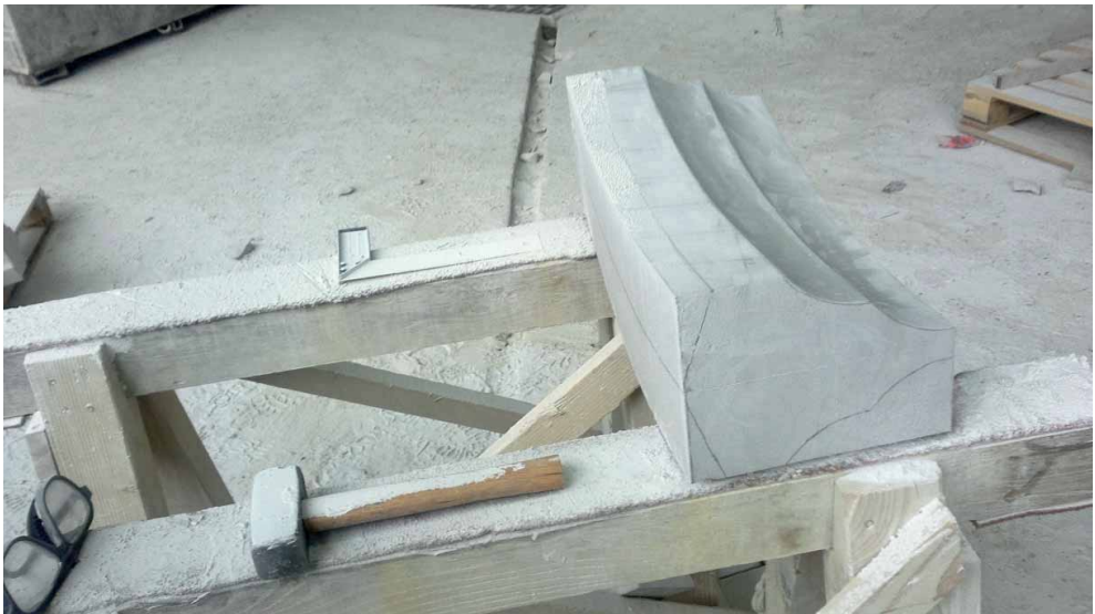
Bild 83 nach Abarbeitung oberer Krümmung wird doppelte Kehle genau wie bei Orthogonalprojektion ausgearbeitet
