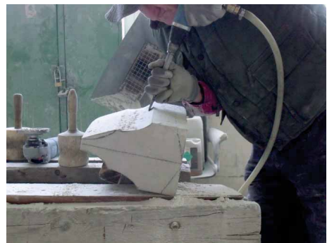
Bild 56 Ausarbeiten Kehlung Außenseite
