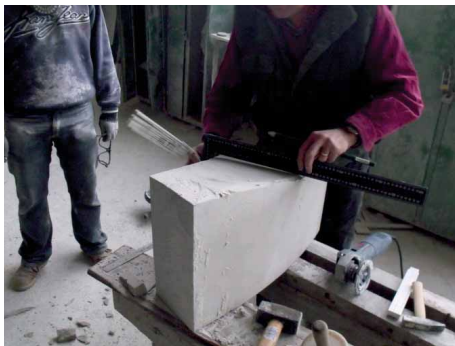
Bild 27 Prüfen (radiale Rechtwinkligkeit) Krümmung Unterseite
