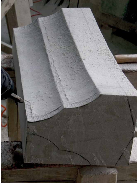
Bild 87 Ausarbeitung der Kehlungen mit beginnendem Randschlag und danach sphärisch gekrümmte Kehlfläche freihändig
