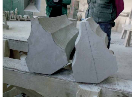
Bild 104 und 105 Vergleich beider Rippenwerkstücke – augenscheinlich außer Handschrift der Oberflächenbearbeitung keine Unterschiede
