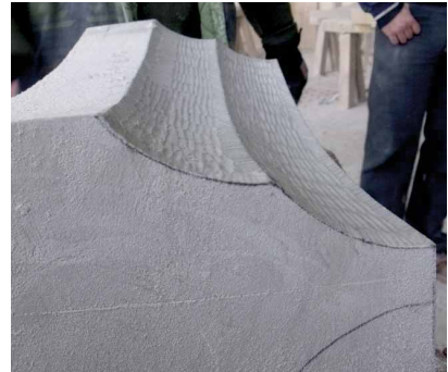
Bild 93 und 94 Ausarbeitung der Kehlungen mit beginnendem Randschlag und danach sphärisch gekrümmte Kehlfläche freihändig
