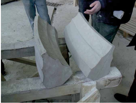
Bild 104 und 105 Vergleich beider Rippenwerkstücke – augenscheinlich außer Handschrift der Oberflächenbearbeitung keine Unterschiede
