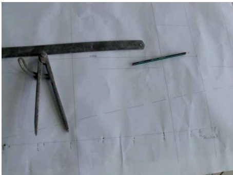
Bild 69 Unterteilen der Bogenaustragung in 8 gleiche Teile und Fällen des Lotes über jeden Einzelteilung
