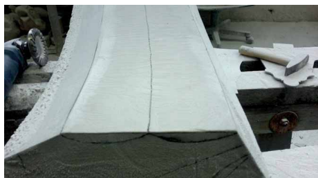
Bild 45 Abarbeiten Schräge über doppelte Kehle, damit Reißen der mittleren Kehllinie längs der Rippe möglich ist
