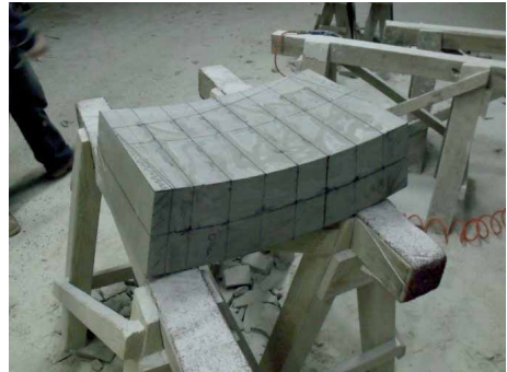
Bild 78 Reißen Fugenfläche im Aufriss
