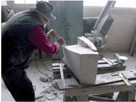
Bild 25 Abarbeiten Krümmung Unterseite
