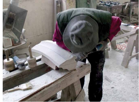
Bild 52 Ausarbeiten Kehlung Außenseite
