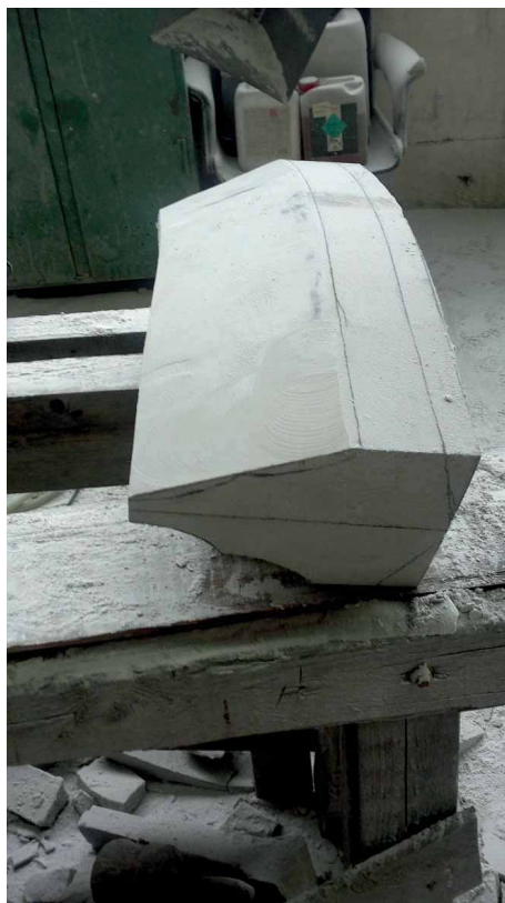
Bild 48 nach Fertigstellung Kehlung Innenseite, Werkstück wenden Schräge für Kehlung Aussenseite abarbeiten
