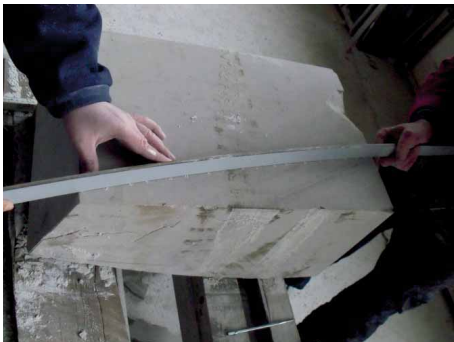
Bild 19 gekrümmte Lehre über gestochene Punkte ausrichten
