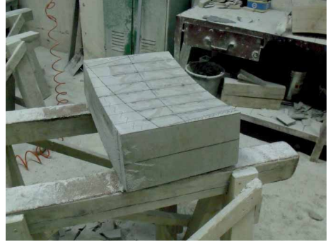
Bild 80 Reißen Fugenfläche im Aufriss
