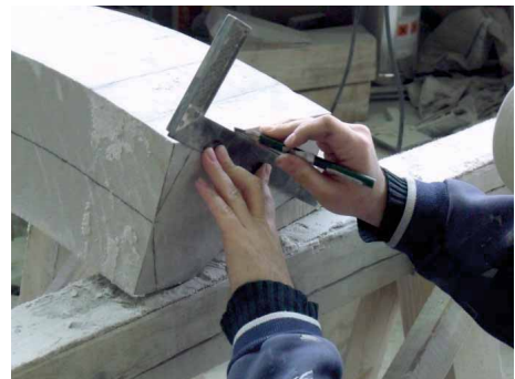
Bilder 95 und 96 nach Kehlung Innenseite Krümmung drehen und Kehllinien Außenseite auf Fugenfläche reißen und nach Abarbeiten der Schräge über der Kehlung dann die Kehlmittellinie längs der Rippe durch Reißziehle parallel zur unteren Mittellinie reißen
