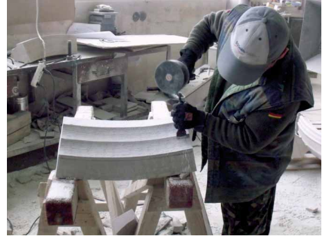
Bild 91 und 92 Ausarbeitung der Kehlungen mit beginnendem Randschlag und danach sphärisch gekrümmte Kehlfläche freihändig
