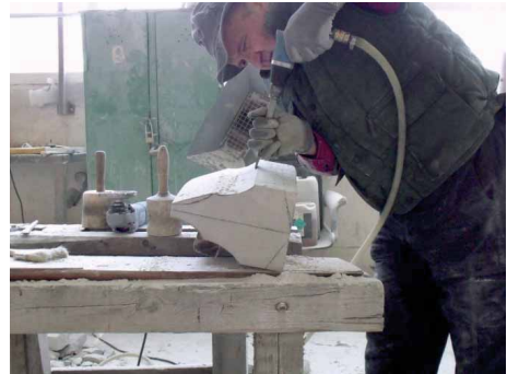
Bild 54 Ausarbeiten Kehlung Außenseite
