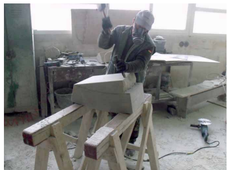
Bild 64 nach den Fugenflächen wird Innenkrümmung ausgearbeitet
