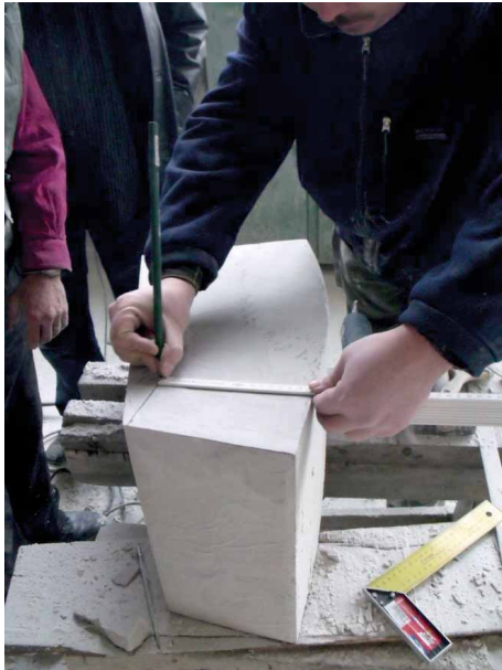
Bild 35 Reißen Innenradius auf gekrümmte
