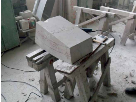
Bild 15 Werkstein drehen fürs Reißen der Bogenaustragung
