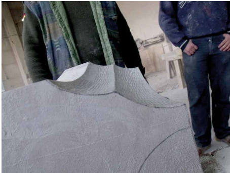
Bild 93 und 94 Ausarbeitung der Kehlungen mit beginnendem Randschlag und danach sphärisch gekrümmte Kehlfläche freihändig
