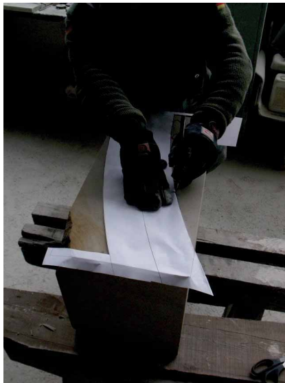
Bild 02 Reißen der Grundrissfigur auf dem planebenen Rohblock
