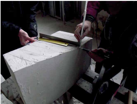
Bild 33 Prüfen (radiale Rechtwinkligkeit) Krümmung Unterseite
