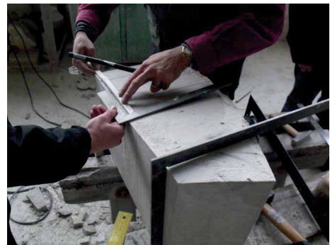
Bild 28 Prüfen (radiale Rechtwinkligkeit) Krümmung Unterseite
