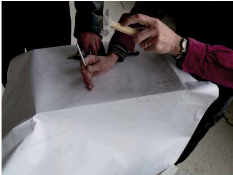
Bild 17 Reißen / Durchstechen Bogenaustragung mit Reißnadel
