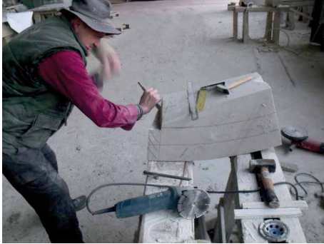
Bild 39 Abarbeiten innere Krümmung
