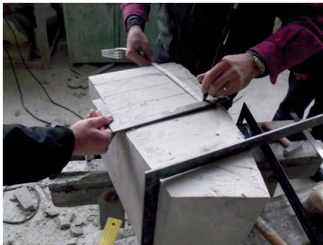
Bild 29 Prüfen (radiale Rechtwinkligkeit) Krümmung Unterseite
