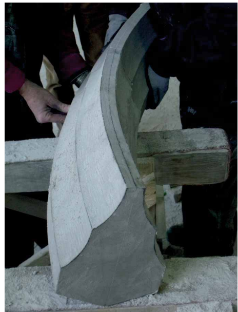
Bilder 102 und 103 Vergleich Krümmung und Oberflächen durch Aneinanderhalten beider Rippenwerkstücke
