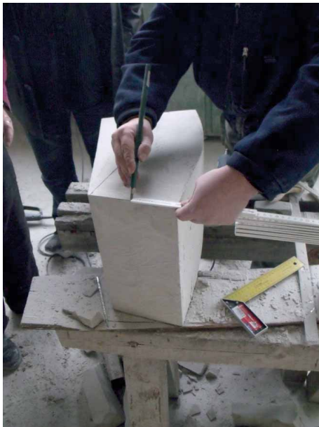
Bild 37 Reißen Untere Mittellinie auf gekrümmter Unterseite
