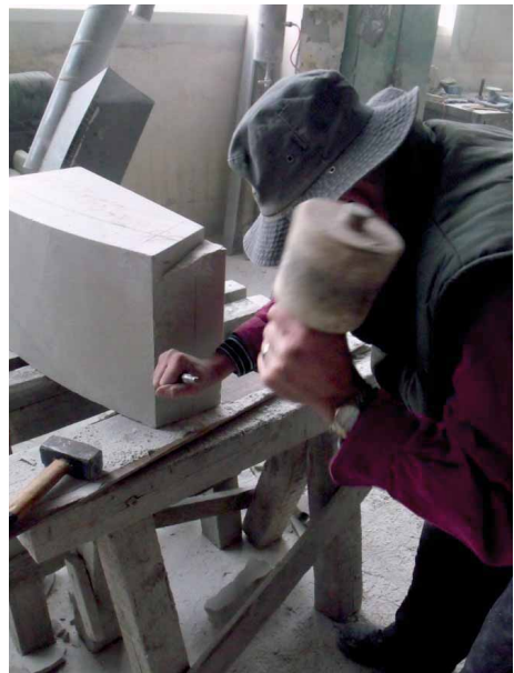
Bild 14 Abarbeiten erste Fugenfläche
