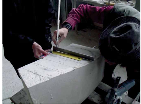
Bild 32 Prüfen (radiale Rechtwinkligkeit) Krümmung Unterseite
