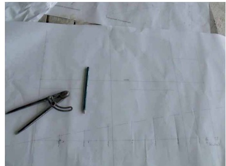
Bild 70 Unterteilen der Bogenaustragung in 8 gleiche Teile und Fällen des Lotes über jeden Einzelteilung
