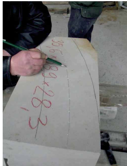
Bild 06 Nachzeichnen Rippenmittellinie über gestochene Punkte
