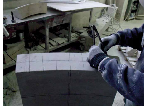
Bild 72 Unterteilen des Krümmings in 8 gleiche Teile auf dem Innenradius (ausgehend aus Teilung Unterseite)
