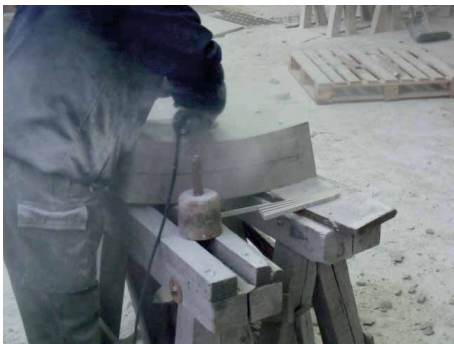
Bild 41 Schleifen Oberfläche innere Krümmung
