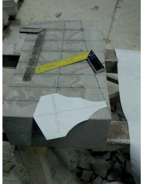
Bild 76 Freihändiges Verbinden der gerissenen Höhenpunkt zum Reißen der Bogenaustragung und danach Reißen der radial ausgerichteten Fuge im Aufriss (Profilmittellinie oder obere Wangenlinie möglich)
