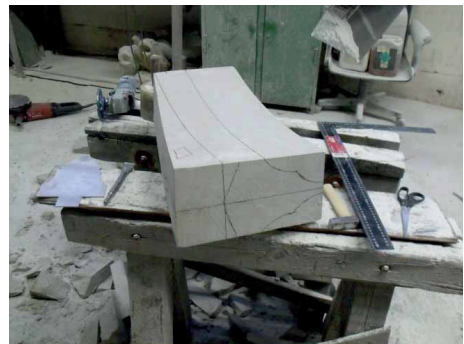
Bild 42 Reißen Profilhauptlinien auf fertigem Krümmling
