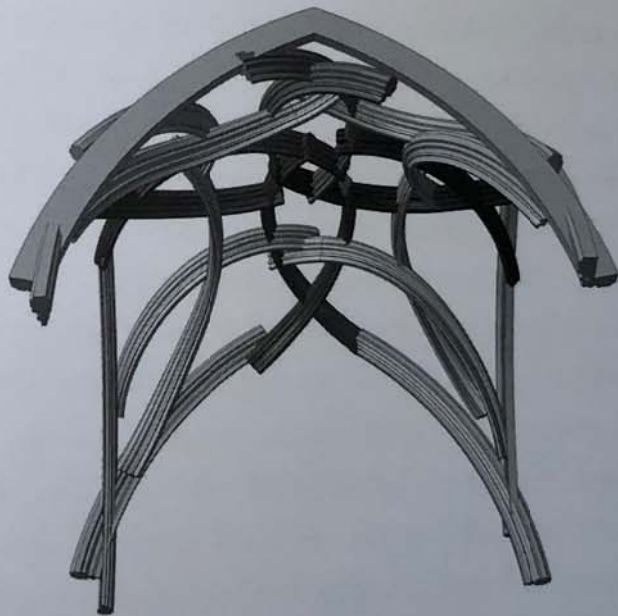
Abb. 2 Gewölbefigur über der Reiterstiege, Hradschin Prag, um 1502. Dekonstruktion in der Bogenaustragung
