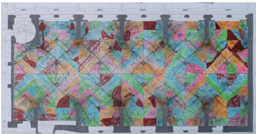
Bild 3. Tageswerke gemauerter Wölbeinzelflächen mit Datumsangabe. Quelle: tagtäglicher Farbeintrag der gemauerten Einzelflächen der Wölbe – auf der Baustelle eingetragen von Thomas Bauer und Steffen Rau in einen Ausführungsplan des AB Anwand
