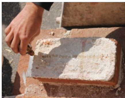
Bild 2. Probekörper Mauerwerk mit Phenolphthaleintest zur Carbonatisierung nach 2 Jahren (Standzeit unter Wetterschutzdach im Freien) zeigt vollständig durchcarbonatisierte Mörtelfuge Fig. 2. Sample of masonry tested with the phenolphthalein test for carbonization after 2 years (standing time in the open air under a weatherproofing roof) shows that the mortar joint had been completely carbonized throughout
