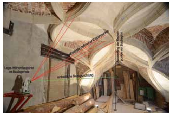
Abb. 17: Vermessung Probejoch Lagenetz und Verformung
