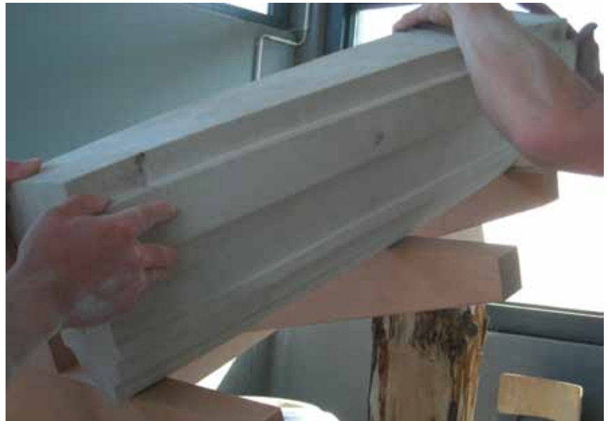
Abb. 4: Modell 2 - Anreißen des über Falllot abgegriffenen Schnittpunktes Grundrissradius und Bogenaustragung der Biege auf den Schiebelehren und Versatz Rippe
