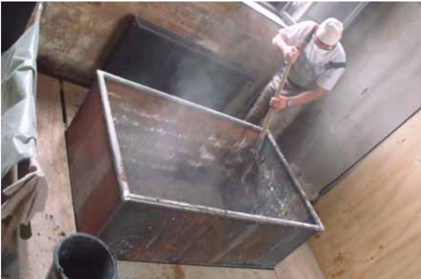
Abb. 50: Fertigung des Handstrichziegels
