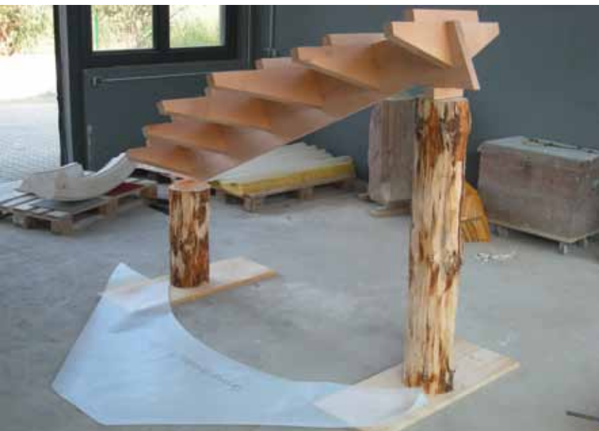
Abb. 2 und 3: Modell 2 – Biege zwischen Knotenpunkten mit Verlauf Prinzipalbogen für Orthogonalprojektion und Schiebelehren sowie Abgreifen des Grundrissradius des Kurvenverlaufes über Falllot
