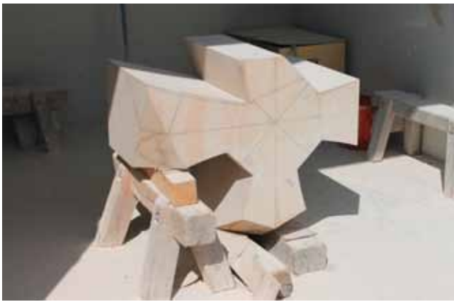
Abb. 42: Steinschnittfolge Knoten über 6-seitige Schablonen
