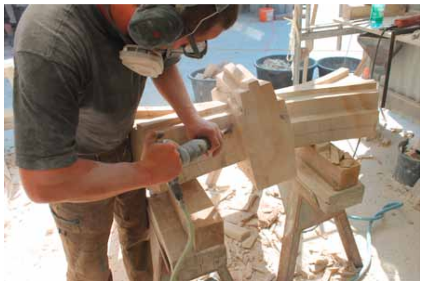
Abb. 44 und 45: Völlig freihändige Ausarbeitung der Rippenprofilkörper am Knoten nach vorherigem Steinschnitt nach 3D-Schablone, hier zu sehen ist die Knotenfertigung mit den Steinmetzen Jens Schrot und Jens Wildenhayn von Fuchs & Girke in Ottendorf-Okrilla
