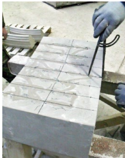
Bild 27. Fertigung Rippe nach Abwicklung Fig. 27. Rib production according to developed view
