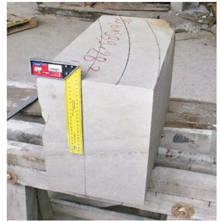
Bild 25. Rohblock-Sandstein für die Fertigung von Modellrippen für die Erasmuskapelle im Berliner Schloss Fig. 25. Raw sandstone block for fabrication of model ribs for the Erasmuskapelle in the Berliner Schloss
