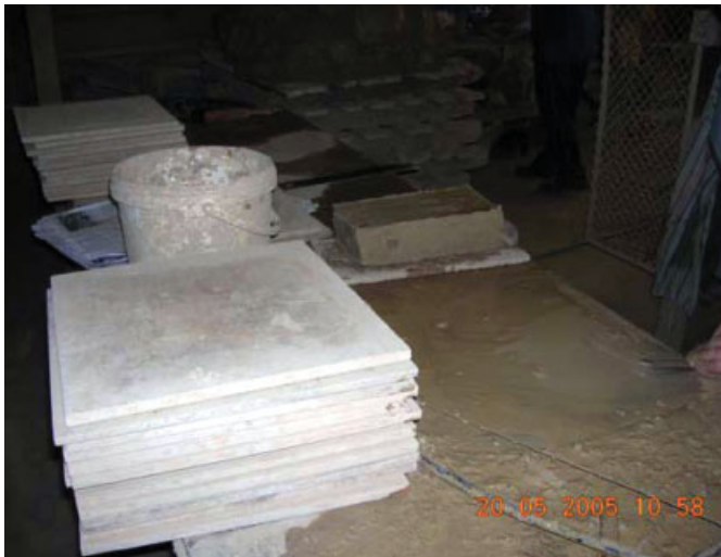
Bild 3. Rohstein nach Abziehen der Holzform Fig. 3. Raw stone after stripping the wooden mould
