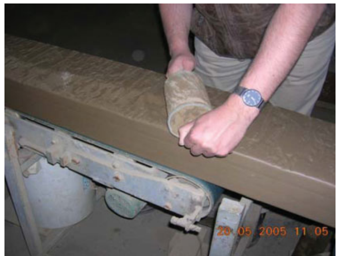
Bild 6. Strukturieren mit Handwalze am Strang Fig. 6. Structure with hand roller on the line
