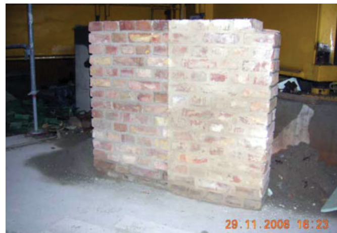
Bild 24. Muster Schlämmmaterial Hinter dem Gießhaus Berlin Fig. 24. Elutriation material sample behind the Giesshaus Berlin
