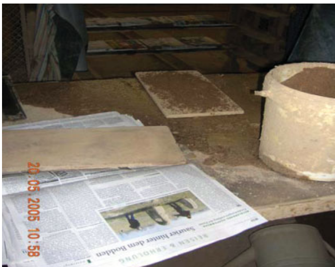
Bild 1. Absanden der Formauflage Fig. 1. Sanding off the mould impression
