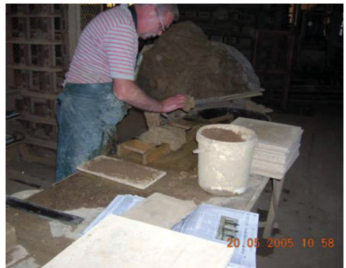
Bild 2. Einkneten des Lehmes in die Holzform Fig. 2. Kneading the loam into the wooden mould
