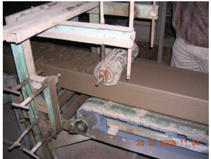
Bild 5. Strukturierung mit Strangwalze Fig. 5. Structuring with strand roll
